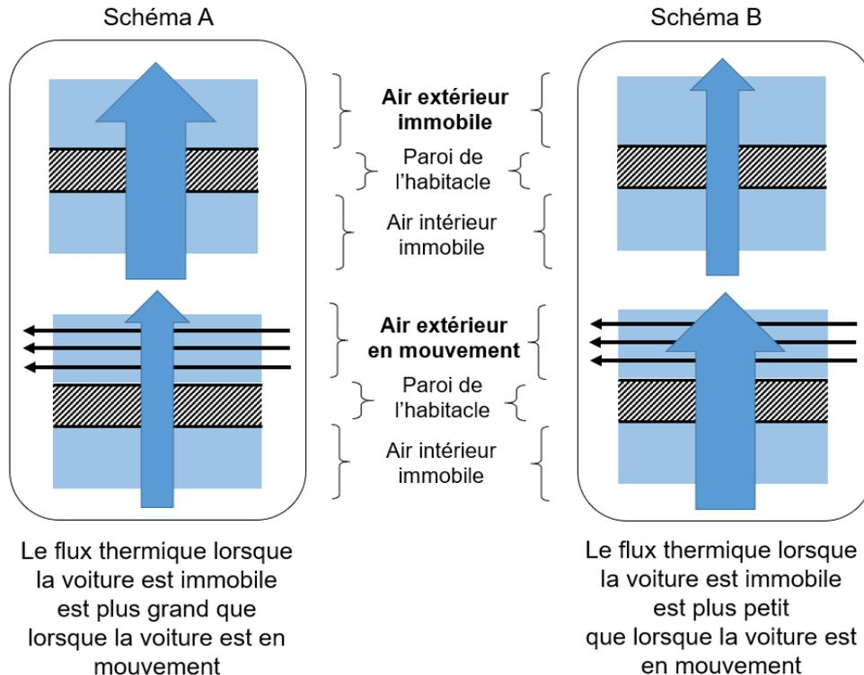
Le schéma B est correct. Le flux thermique vers l'extérieur est plus petit lorsqu'elle est immobile que lorsqu'elle est en mouvement. On peut faire une analogie avec l'eau du café que l'on refroidit en soufflant dessus. L'air en mouvement est plus efficace pour « prendre » de l'énergie au café.
