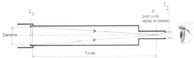
Le principe de cet instrument est de collecter la lumière émise par les astres, de la concentrer et de renvoyer à l'œil une image agrandie de l'objet observé.
