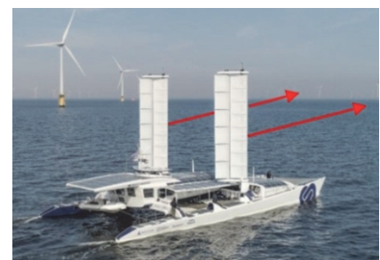
Figure 13 : propulsion de l'Energy Observer avec les Oceanwings
